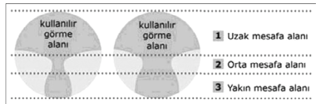
Şekil 12. Standart mültifokal (solda) ve FreeForm teknolojisiyle üretilmiş mültifokal (sağda) camların farkı
