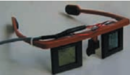
Resim 3. Ferroelektrik obtüratörler bulunan stereo gözlük
